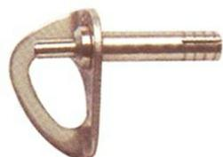
Ensemble complet d'amarrage en acier inoxydable. Composé d'une plaquette COEUR, et d'une cheville auto-expansion. Plaquette démontable. 2 versions : plaquette COEUR montée sur goujon de 10 ou 12 mm.
